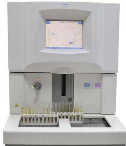
在后来的UF 500/1000i中，采用了半导体激光器，光路系统得到简化，灵敏度增加。
