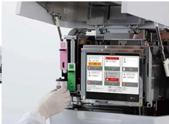
清洗采用了气泡方式，清洗针的内外壁，降低可能存在的交叉污染，还可设置自动清洗。
